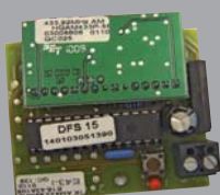
Funk-Empfänger Für Fernbedienung (auch lieferbar mit Gehäuse)
